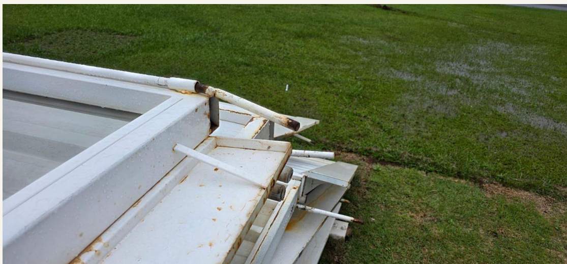
Fotografia 78 — Canto superior de folha sobre o gramado: pino-guia dobrado e tubo do quadro com a extremidade aberta.
